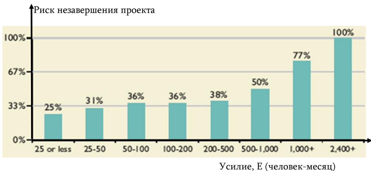
Рис.17.2. Зависимость риска незавершения проекта в области информационных технологий от общего усилия проекта
